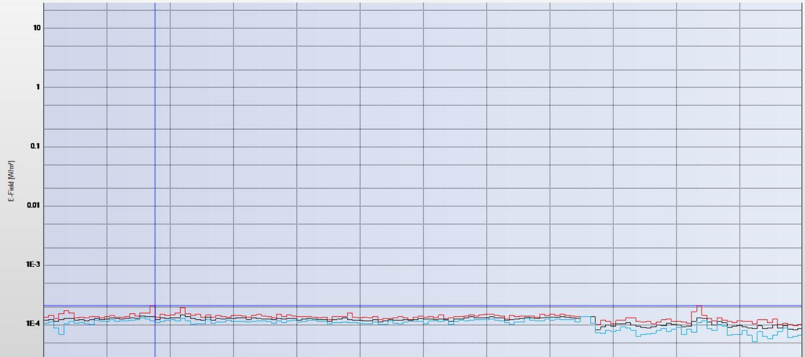
Густина на енергија во текот на мерењето добиена со широкопајсниот инструмент NARDA NBM 550 во интервал од 6 минути
