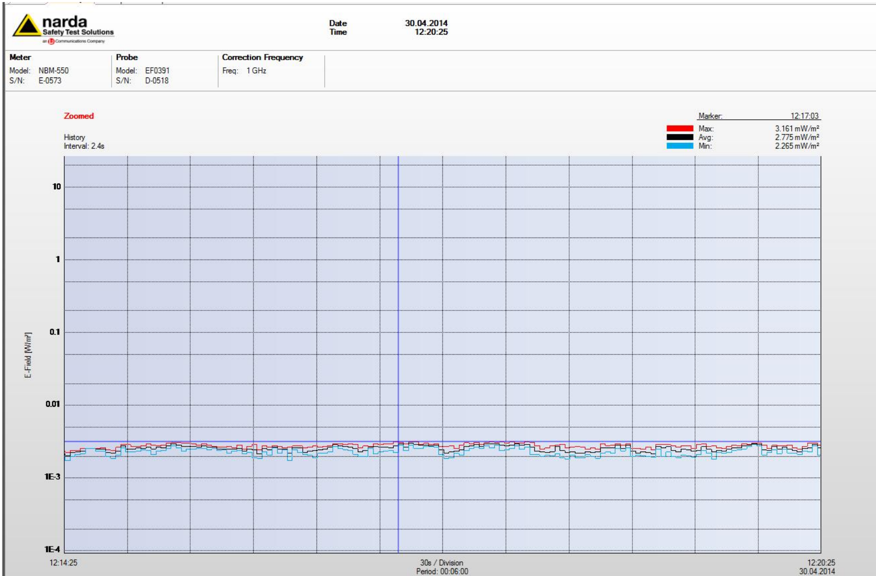
Густина на енергија во текот на мерењето добиена со широкопајсниот инструмент NARDA NBM 550 во интервал од 6 минути
