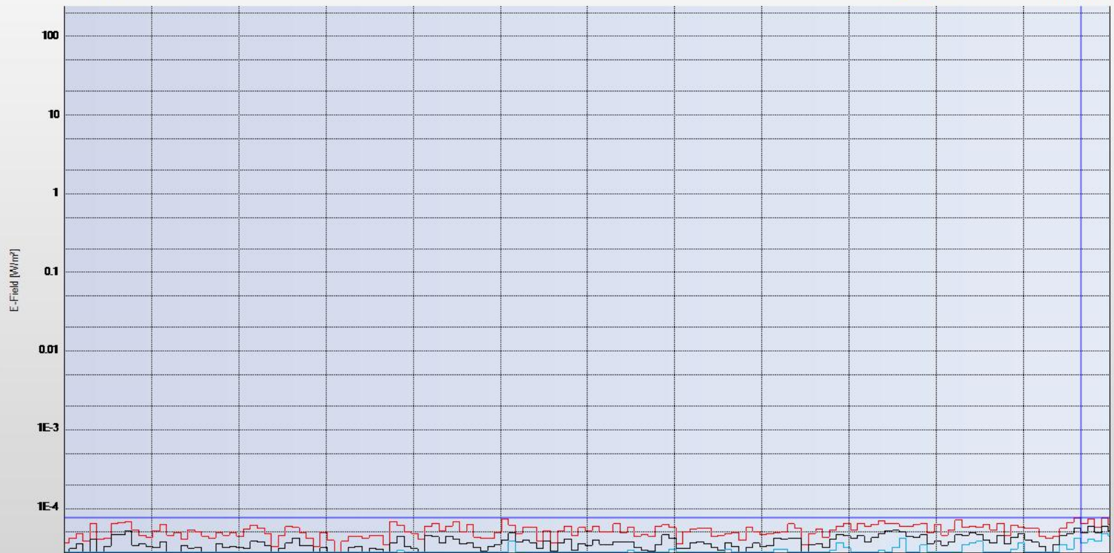
Густина на енергија во текот на мерењето добиена со широкопајсниот инструмент NARDA NBM 550 во интервал од 6 минути
